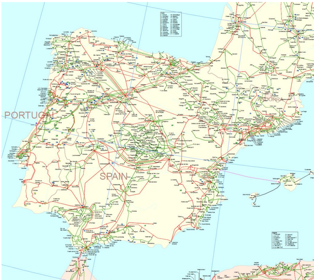
Figura 8 - Mapa da rede elétrica de MAT (apenas nos níveis de 400 e 220 kV) da Península Ibérica e das suas interligações aos sistemas elétricos de França e de Marrocos. [Fonte: ENTSO-E]
