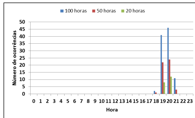
Figura 4.89 - Distribuição horária das 100, 50 e 20 horas mais carregadas no ano de 2014 para o nível de tensão BT (Porto).
