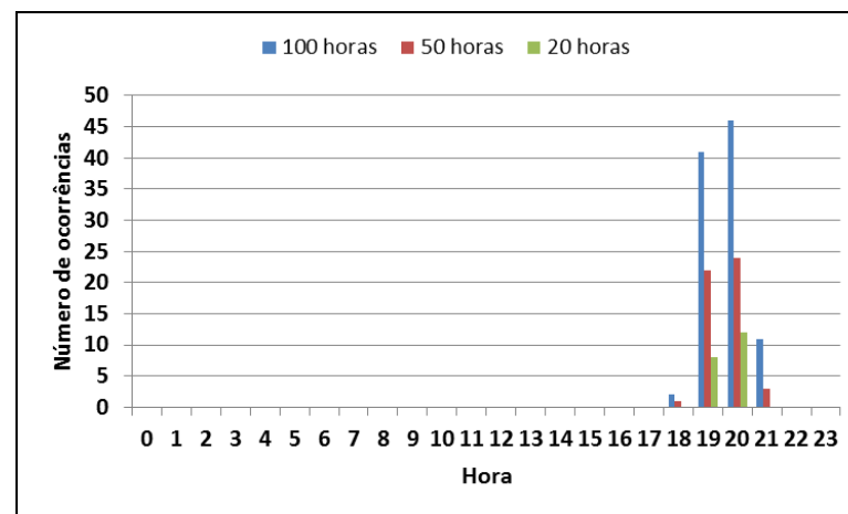
Figura 4.137 - Distribuição horária das 100, 50 e 20 horas mais carregadas no ano de 2014 para o nível de tensão BT (Porto).
