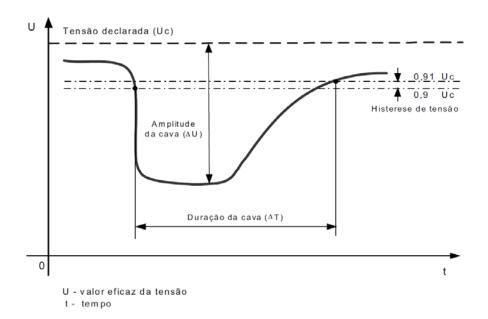
b) O início ocorre quando, num determinado ponto da rede, o valor eficaz da tensão de uma ou mais fases cai repentinamente para um valor situado entre 90% e 5% da tensão de referência deslizante U<sub>rd</sub> (valor eficaz da tensão existente imediatamente antes do início da cava) e termina quando a tensão retoma um valor acima dos 90% dessa tensão de referência acrescida de um valor de histerese (relatório técnico CEI 61000-2-8).
