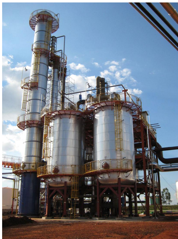
Figura 4-39 – Unidade de destilação convencional + sistema de purificação de etanol em peneiros moleculares, para produção de etanol hidratado e etanol anidro [298]
