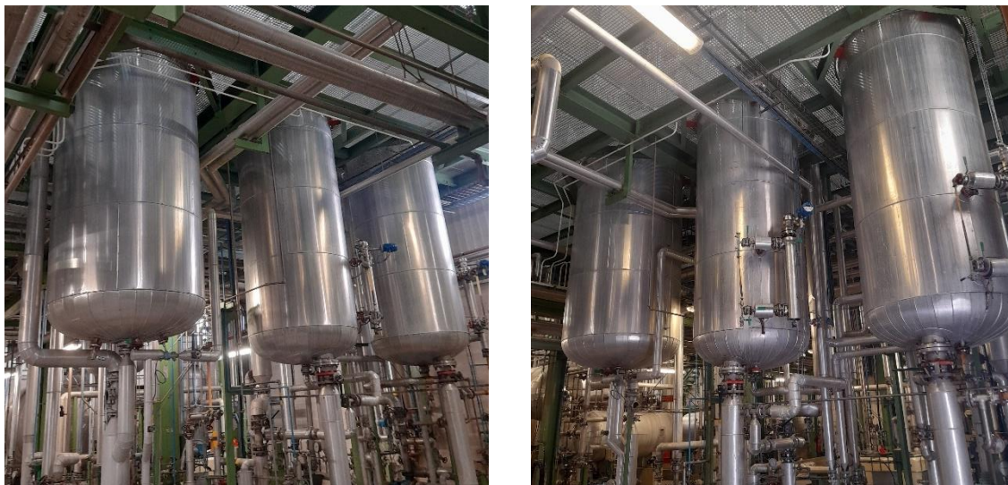
Figura 2-17 – Unidade de transesterificação com catálise homogênea alcalina - Desmet Ballestra (Cortesia da Fábrica Torrejana – trens de reatores 1 e 2)
