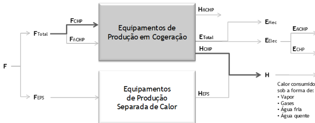
Figura 2 - Representação gráfica de uma Instalação de Cogeração com equipamentos de produção em cogeração (processo ou unidade de cogeração) e equipamentos de produção separada de calor e identificação das principais variáveis objeto de medição.
