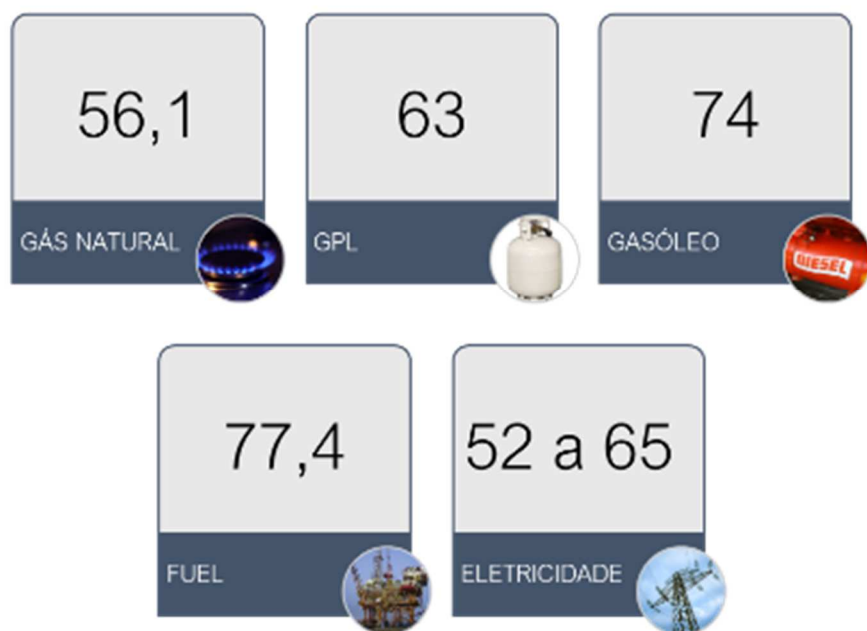
Figura 46 - Emissões de CO 2 por fonte de energia 35
