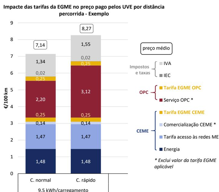
Exemplo para um cenário de 9,5 kWh/carregamento, em pontos de carregamento com entrega da rede elétrica em baixa tensão, tanto para pontos de carregamento rápidos (potência acima de 22 kW), como normais (potência até 22 kW), assumindo um consumo de 15 kWh/100 km para o veículo elétrico.
