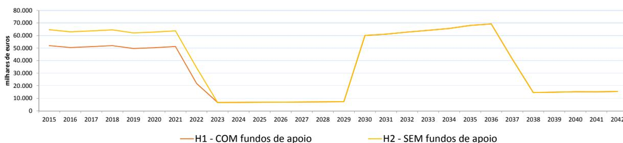
A instalação de contadores inteligentes impacta no OPEX e no CAPEX do operador da rede de distribuição de modo diferente. A maior visibilidade dos benefícios associados à instalação de contadores está ao nível do OPEX. A Figura 4-4 apresenta o impacto anual no OPEX resultante da instalação de contadores inteligentes no cenário 2.
