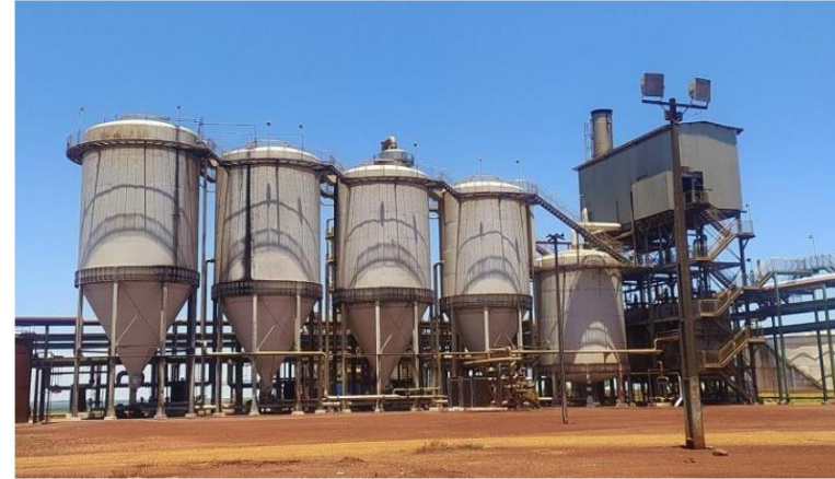
Unidade de fermentação de uma fábrica de bioetanol - processo contínuo
