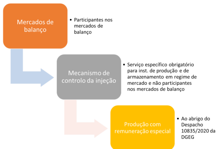
Figura 3-1 – Esquema de prioridades de aplicação do mecanismo de controlo de injeção na rede
