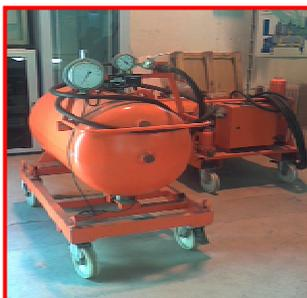
Aquisição de equipamentos para controlo de fugas de SF6 e recuperação do gás SF6
