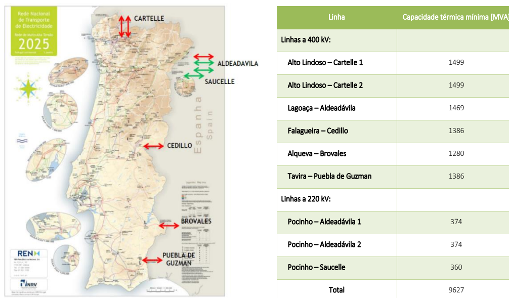
Figura 11 – Linhas da interligação entre Portugal e Espanha e capacidades térmicas das linhas 88
