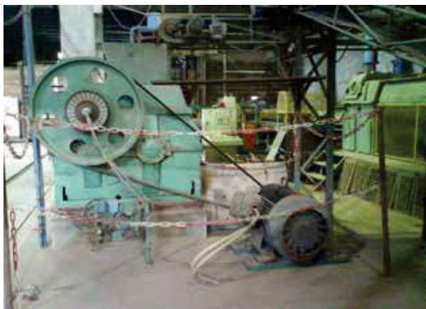
Figura 52 - Fieira a vácuo sem variador eletrônico de velocidade
