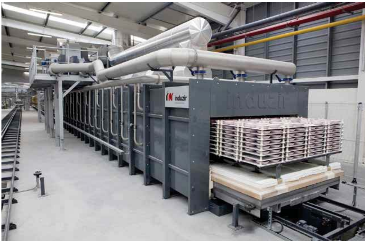
Figura 65 - Forno contínuo de rolos com recuperação de ar quente (fonte: INDUZIR)
