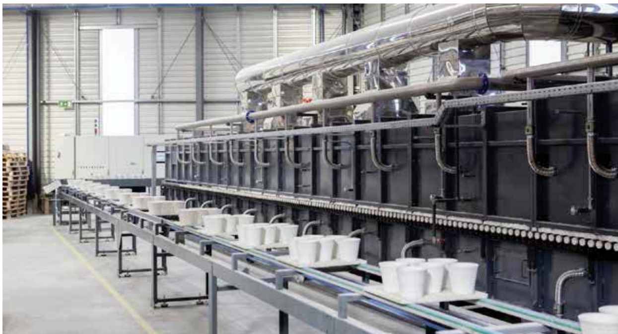
Figura 46 - Exemplo de um forno de rolos (fonte: INDUZIR)
