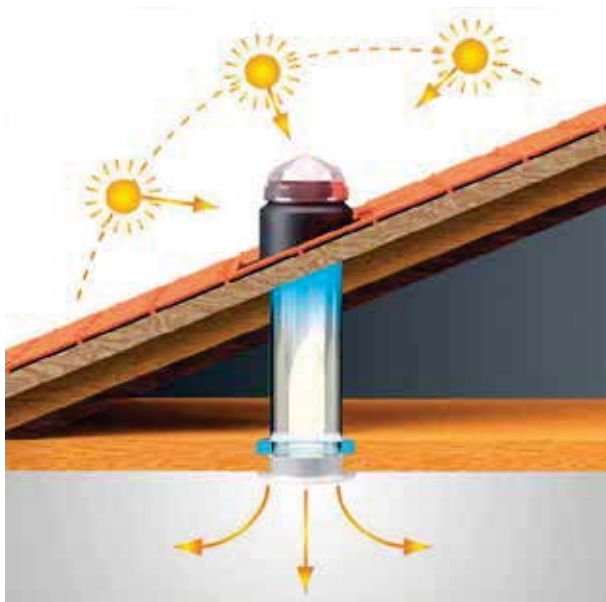
Figura 60 - Esquema de funcionamento de um tubo solar (fonte: CHATRON)
