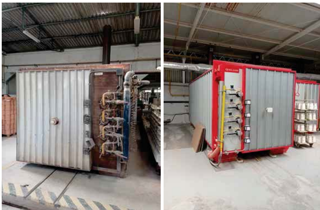
Figura 67 - Exemplo de fornos cerâmicos antes e após retrofit / substituição
