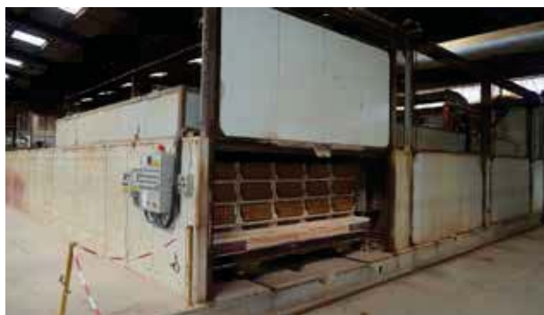
Figura 44 - Exemplo de um secador estático com várias câmaras (fonte: SOTELHA)
