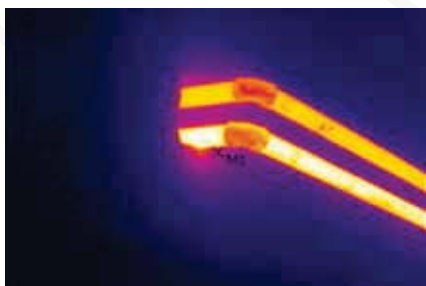
Figura 63 - Termografia de tubagens de água quente para o enchimento, sem isolamento
