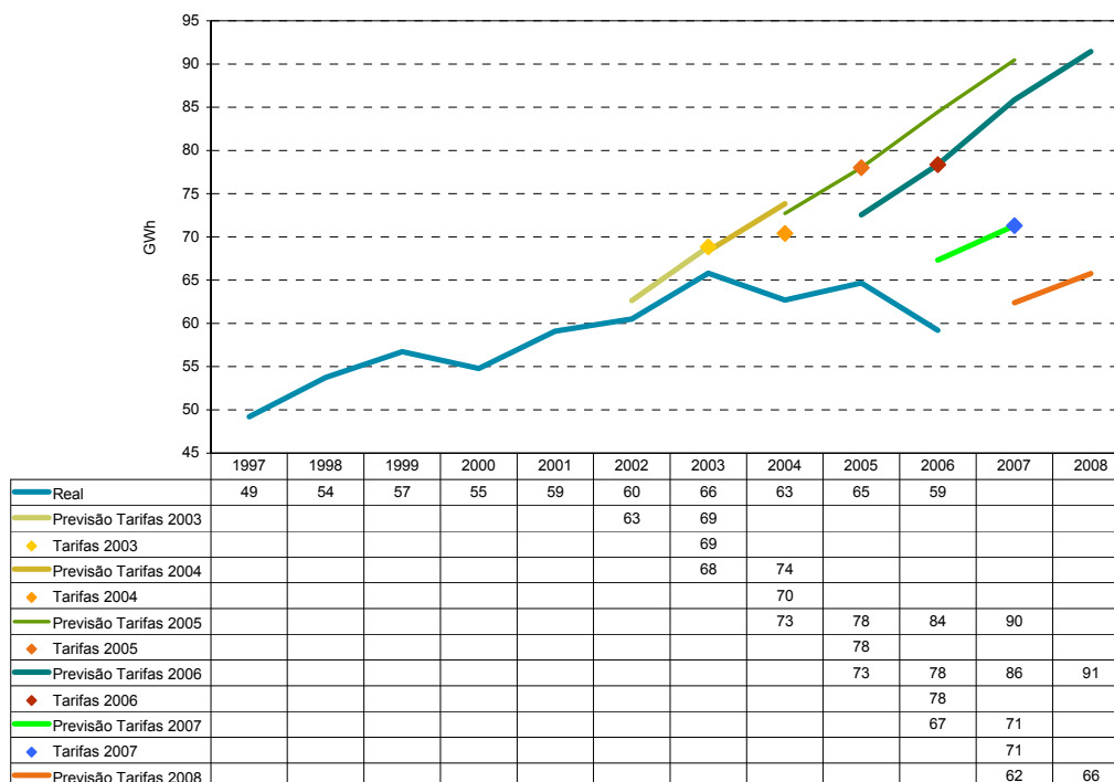
Figura 3-4 - Perdas nas redes de transporte e distribuição da RAA
