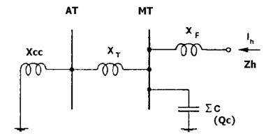
O módulo da impedância harmónica de ordem h da rede vista do ponto de interligação MT,  $Z_h$ , pode ser obtido de forma aproximada utilizando a figura seguinte:
