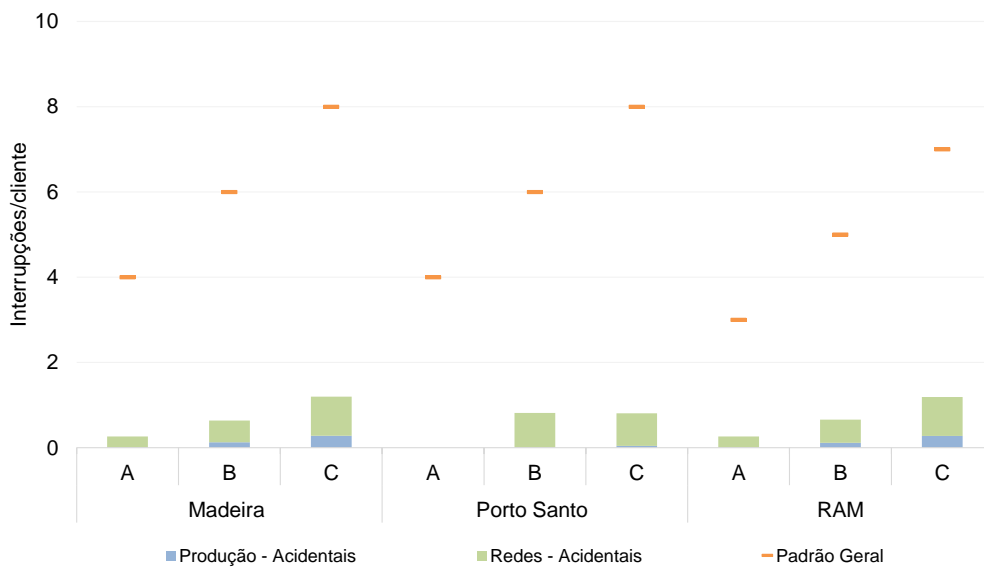
Figura 3-27 – SAIFI BT na RAM – comparação com o padrão, em 2017
