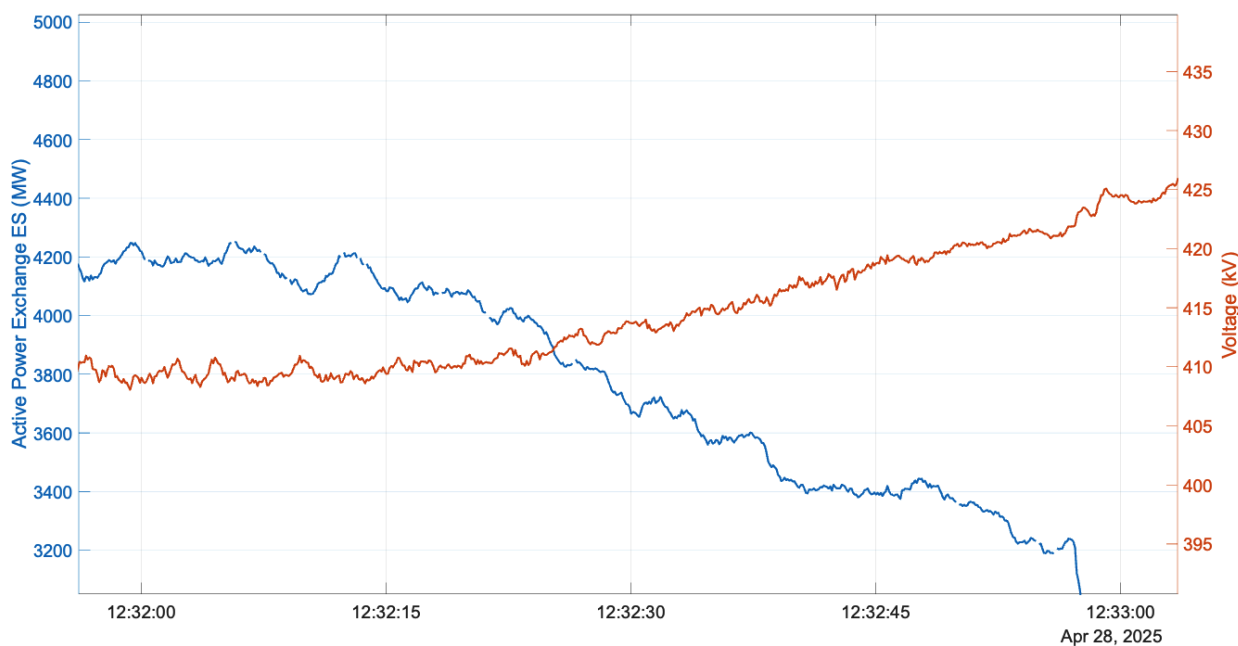
Figura 11: Evolução da tensão na subestação de Carmona e da posição de troca de potência ativa líquida da Espanha no minuto anterior ao apagão (fonte: dados PMU da Red Eléctrica)
