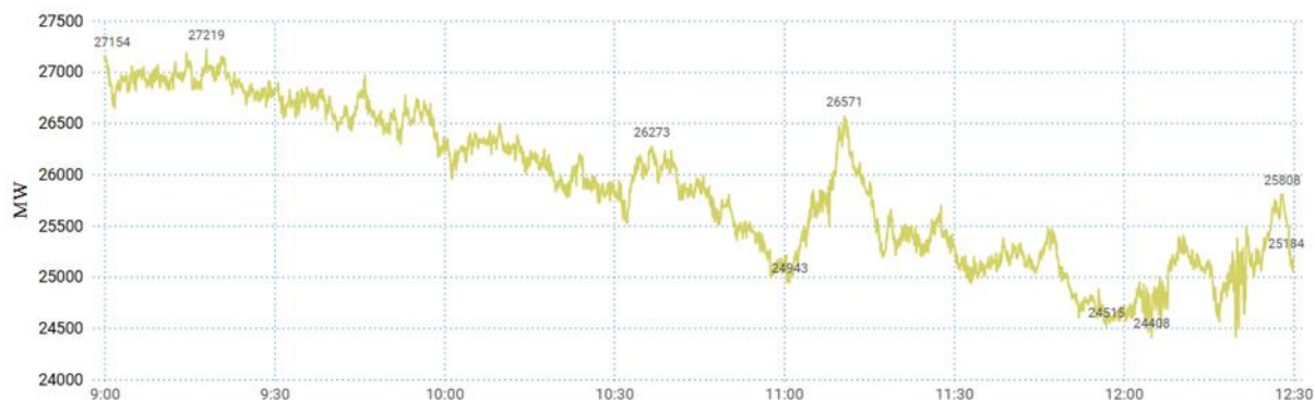
Figura 7- Carga fornecida pela rede espanhola entre as 09:00 e as 12:30 CEST
