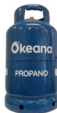
Tipo - T3 Propano - 11 kg Observações (Redutor) Ligação rápida Clip-on Ø 22mm (apenas nos arquipélagos da Madeira e dos Açores) Código EN 15202 G.54 Compatibilidade T3/4-P-G.54
