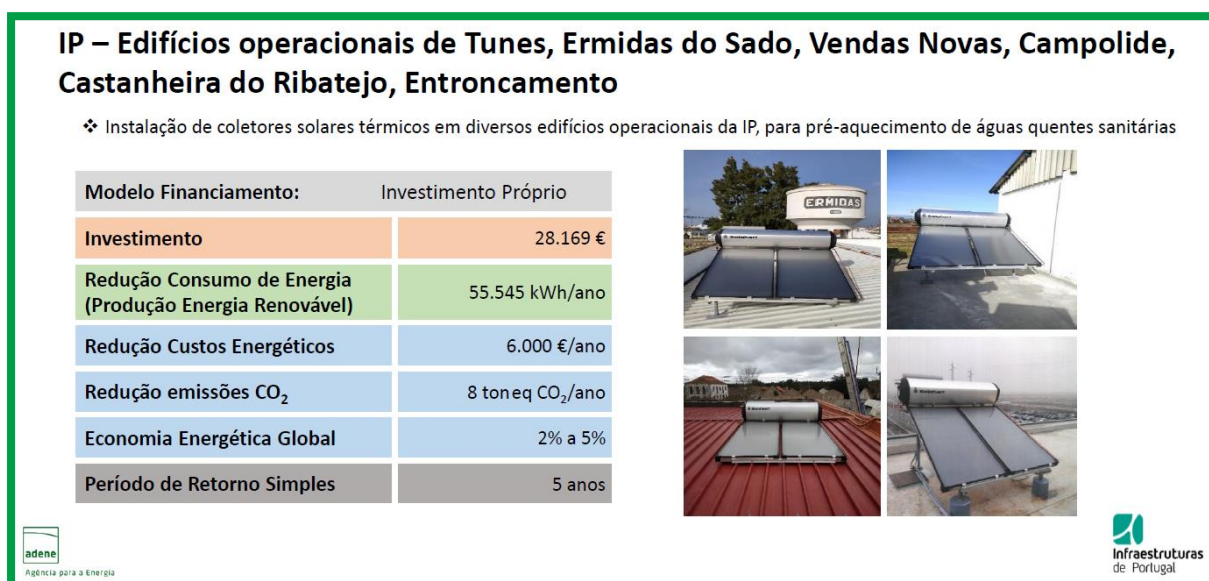
Figura 13: Caso de sucesso de implementação de coletores solares térmicos em instalação da AP
