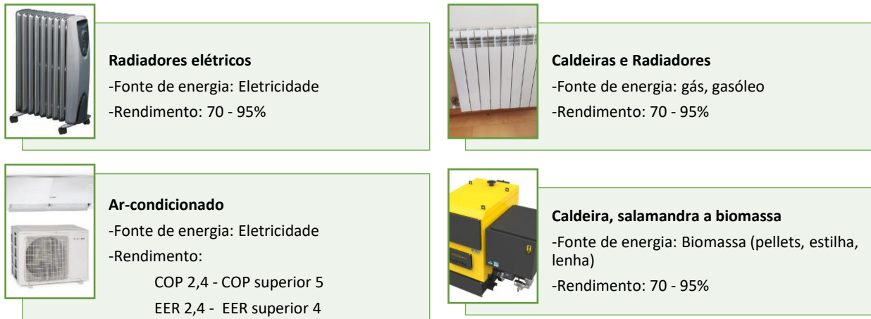
Figura 14: Tipos de equipamentos de climatização
