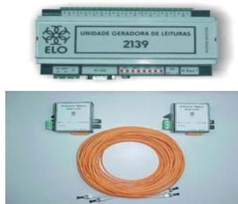
Figura 6 – Instalação de um medidor com saída de impulsos a jusante do contador, para adaptação de contador existente a telecontagem.
