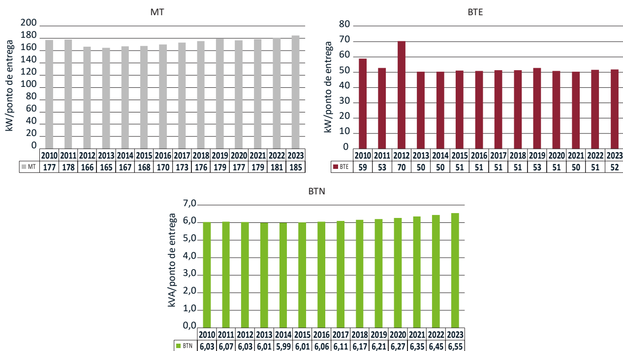
Figura 4-15 – Potência contratada média por ponto de entrega e por nível de tensão / tipo de fornecimento, na RAA
